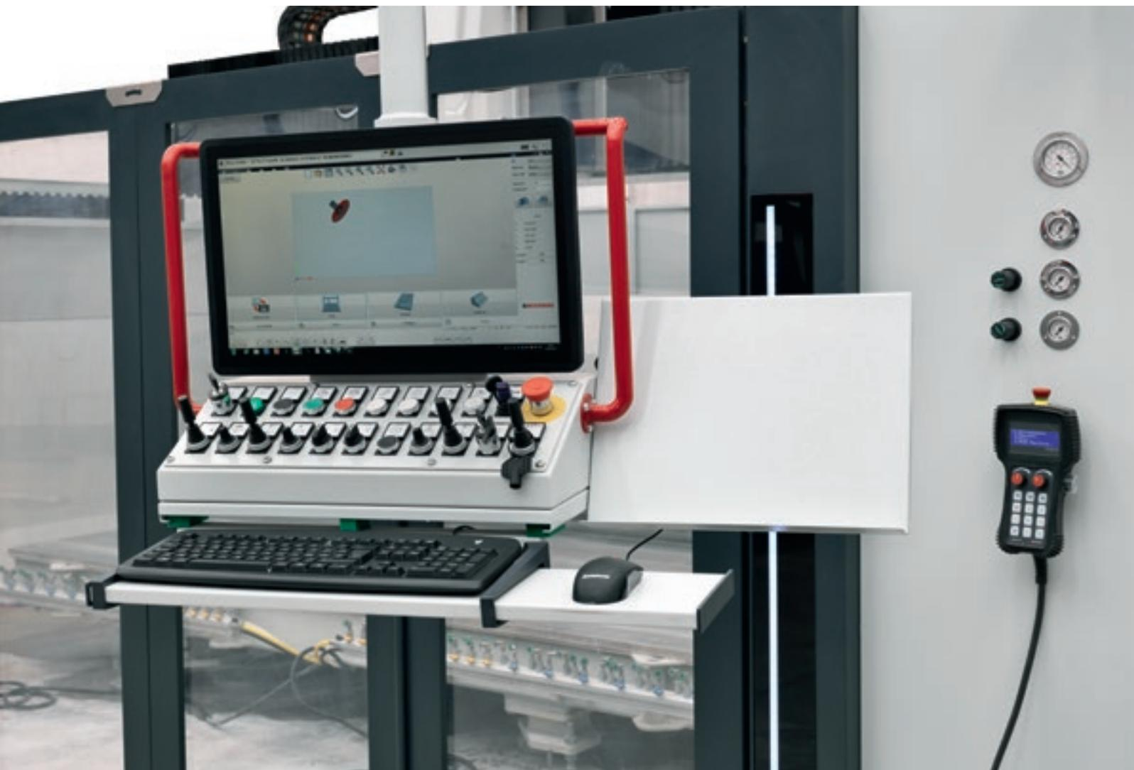
L'utilisation d'un PC doté d'un système d'exploitation Windows garantit une approche extrêmement simple et intuitive pour l'opérateur et assure une connectivité complète avec les systèmes de réseau et les supports optiques/ magnétiques disponibles sur le marché.
