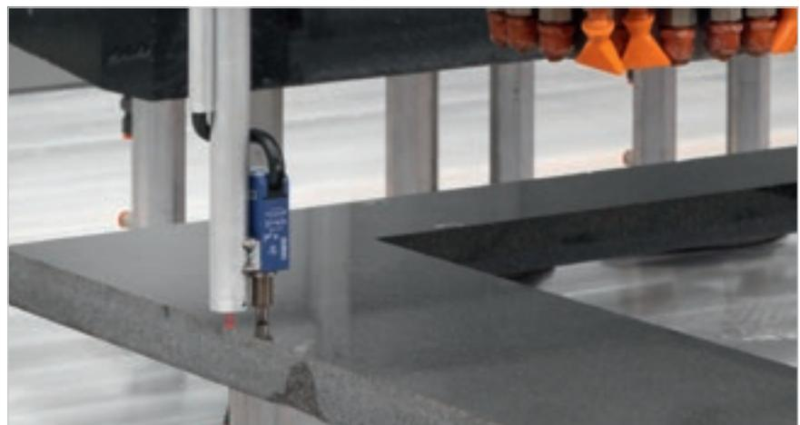
Le palpeur à Z variable permet de maintenir une qualité constante d'usinage même sur les pièces ayant une épaisseur irrégulière.
