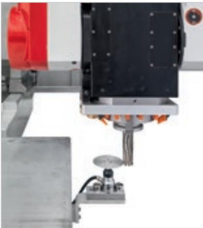
Le présélecteur mécanique, grâce au système totalement automatique, permet d'avoir facilement et rapidement une mesure toujours précise et à jour des outils durant les processus de façonnage, en évitant ainsi tout type d'erreur de la part de l'opérateur.
