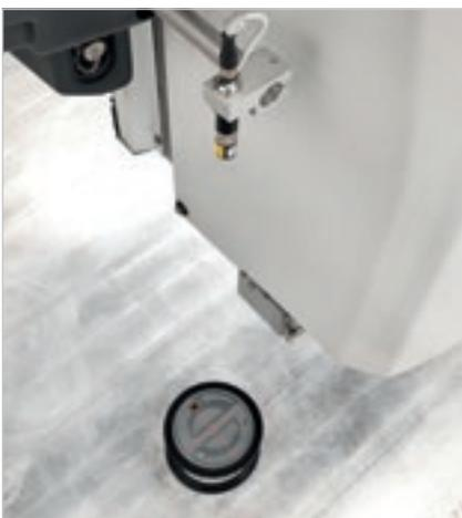
Le laser en croix guide l'opérateur pour le positionnement des ventouses et butées en accélérant les opérations d'équipement du plan.
